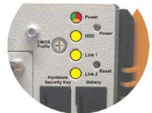
그림 21 Automation PC810 의 상태 LED
