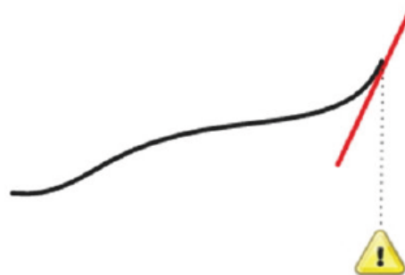
그림 8 Rate-of-change monitoring alarm
